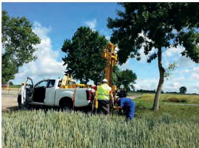
Rys. 2.6. Wiercenie sond badawczych – poligon badawczy Łebień
